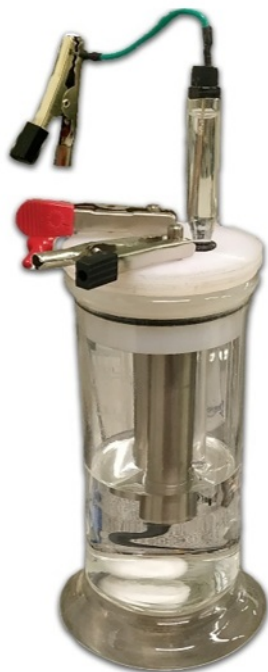
Figura 1. Eletrolisador com eletrodos de Ti projetado para realizar as análises de cronoamperometria.
